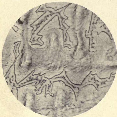
Fig. 21. \times 2050 Cu 78.2 Sn 15.5 Zn 6.3.
